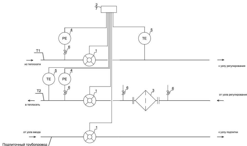
1 - расходомер горячей воды, 2 - тепловычислитель, 3 - фильтр, 4 - преобразователь давления, 5 - термопреобразователь, 6 - кран пробковый трехходовой, 7 - шкаф для тепловычислителя
